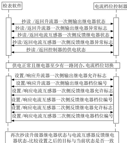
图 4 高压侧电流档位切换控制流程图
